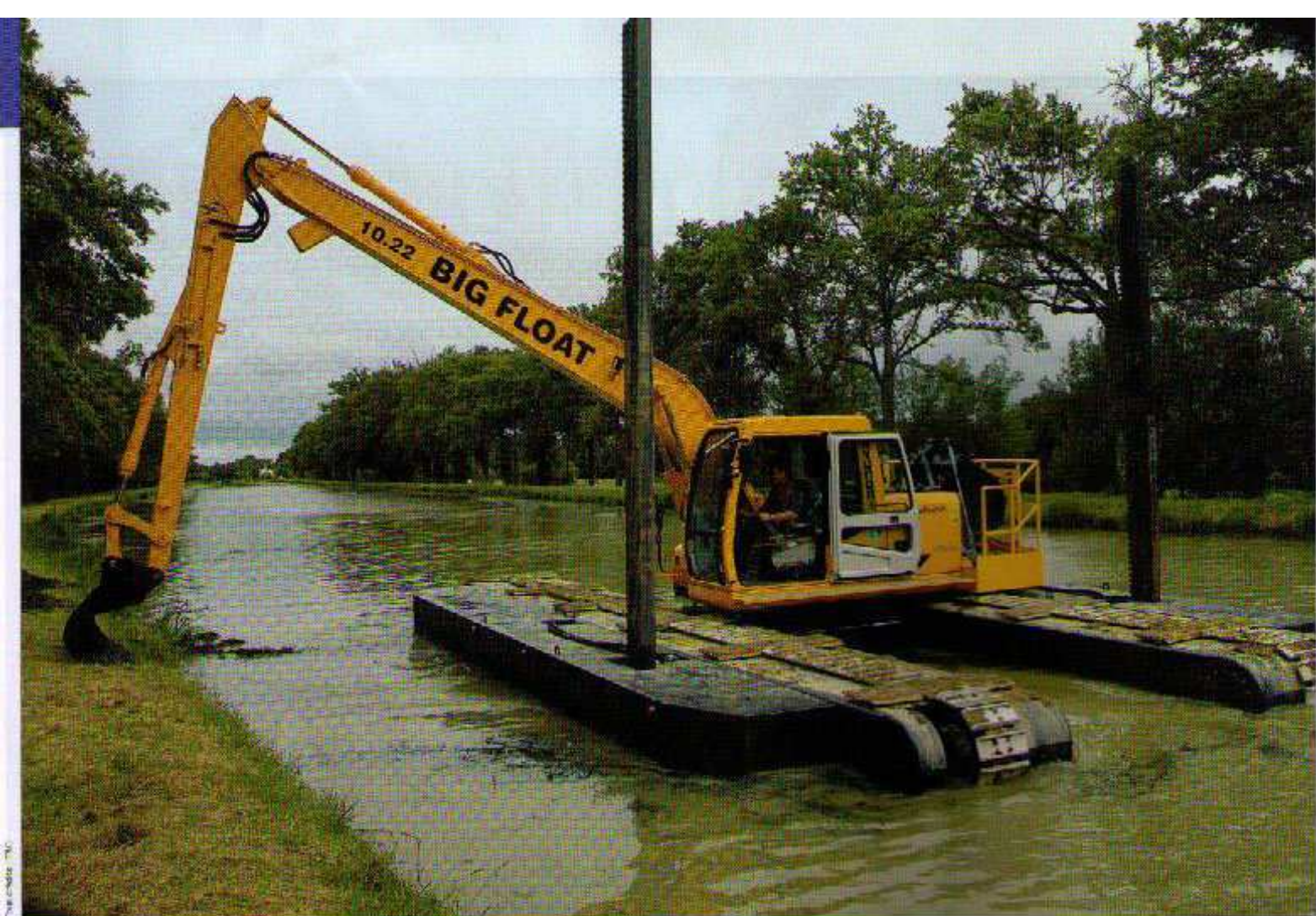
Pour se déplacer, la pelle utilise son bras en appui sur les rives ou au fond de l'eau.
