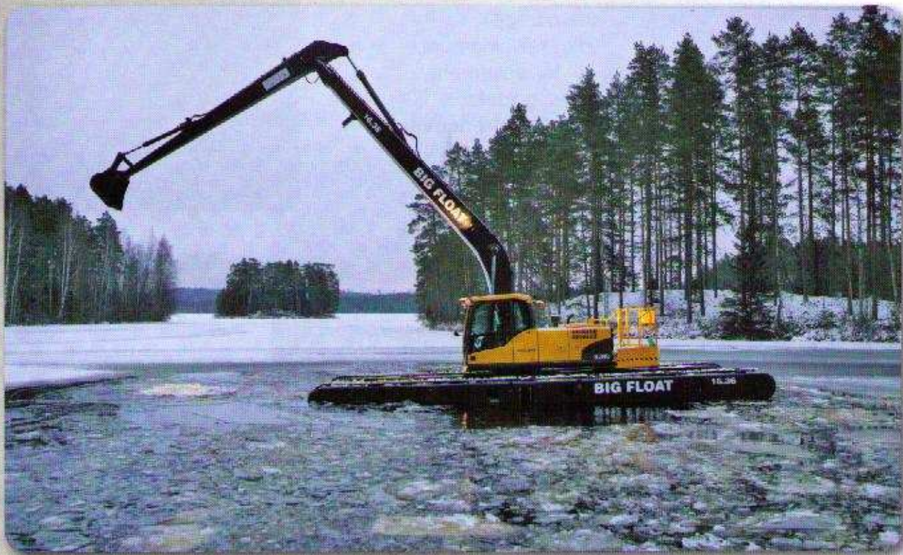
Pelle amphibie BIG FLOAT et ses pontons additionnels
