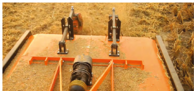
Roue d'ajustement de hauteur de coupe
