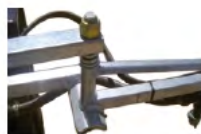
Verrouillage des bras avec ressort
