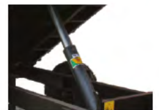
Cylindre hydraulique télescopique
