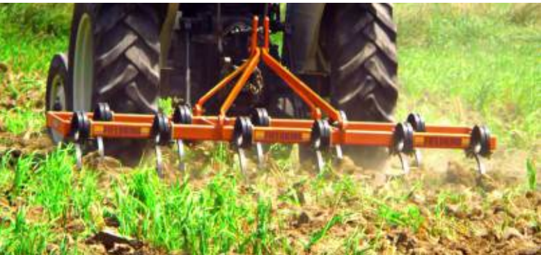
Dent double ressort en acier type EN-45
