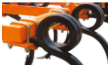
Forme adaptée des dents qui empêche le colmatage
