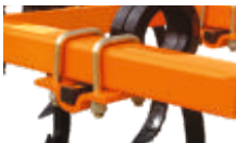
Bride de fixation en U pour fixer et ajuster les dents
