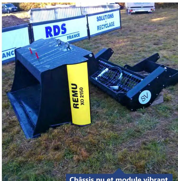
Châssis nu et module vibrant
