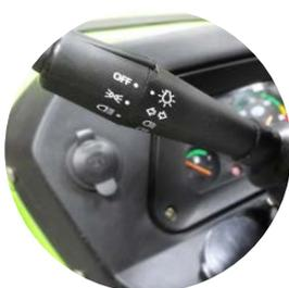
**Commutateur** : le commodo de série permet d'activer facilement les clignotants, les dispositifs d'éclairage et le klaxon.
